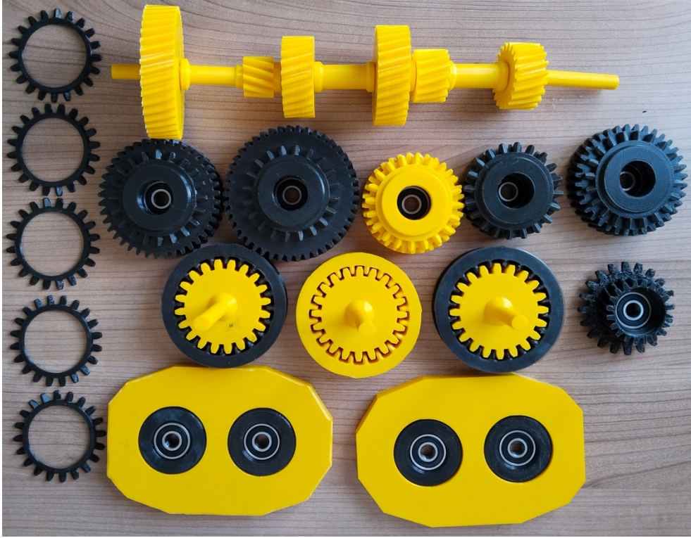
Şekil 6. Şanzıman parçalarının 3B yazıcı ile üretimi
